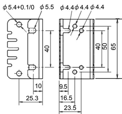
图2 支架尺寸图 (mm)
