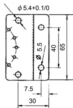
图3 窄间距支架尺寸图 (mm)
