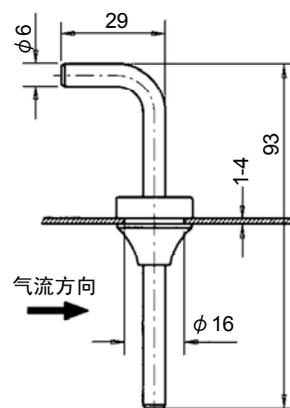
图4 皮托管尺寸图 (mm)
